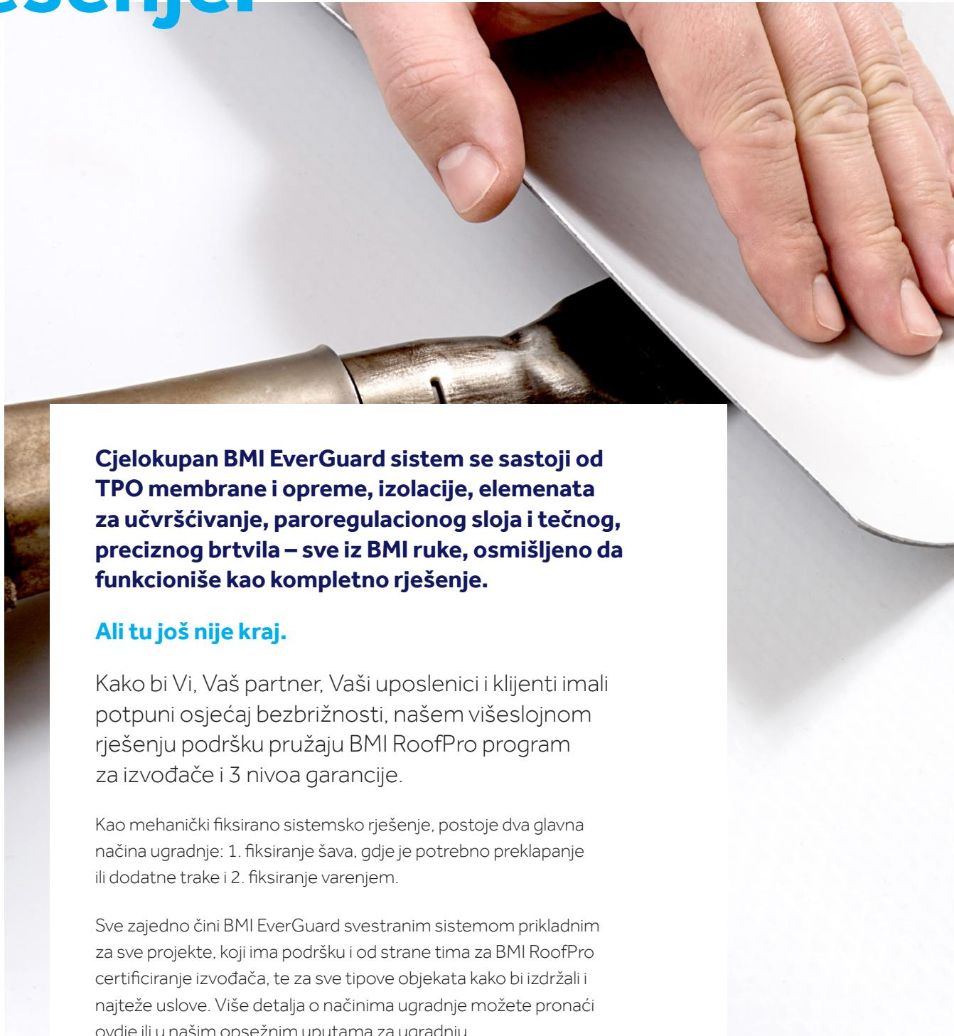
**Cjelokupan BMI EverGuard sistem se sastoji od TPO membrane i opreme, izolacije, elemenata za učvršćivanje, paroregulacionog sloja i tečnog, preciznog brtvila – sve iz BMI ruke, osmišljeno da funkcioniše kao kompletno rješenje.**
